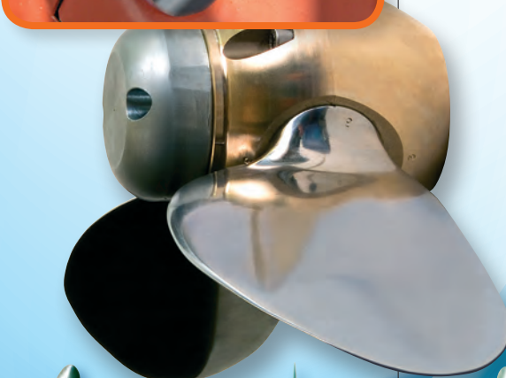
Lames en position pour avancer
